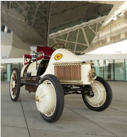
Lohner Porsche 1900, uitgevoerd met een electromotor per wiel. [R] GM Chevrolet EV1 c. 1990, een experimentele elektrische auto.
